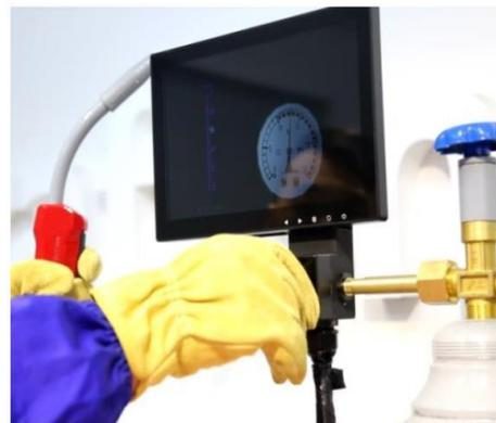
(13) 规范佩戴焊接面罩，使用仿真焊枪，完成汽车前纵梁板件上部接缝、中部接缝、下部接缝处的连续焊。
